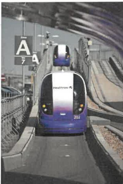
Depuis 2011, l'aéroport de Londres Heathrow dispose d'un parc de véhicules électroniques sans conducteur circulant sur une voie réservée. Conçues par la société britannique Ultra PRT, ces navettes autonomes (baptisées "pods") assurent le transfert de quelque 1000 passagers du terminal 5 aux parkings de l'aéroport. (Photo: Ultra PRT)
