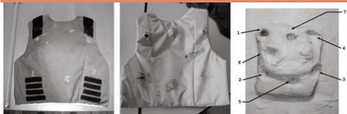
Figure 6 : (gauche) face avant du gilet pare-balles avec la localisation des 6 points d'impact - (milieu) visualisation des zones déformées en face arrière du gilet - (droite) empreintes des déformées dynamiques aux 6 points d'impact dans la plastiline Roma n°1.
