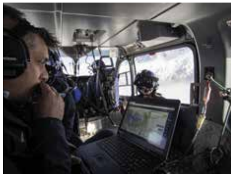
Expérimentation d'un appareil de recherche électronique de personne embarqué en hélicoptère
