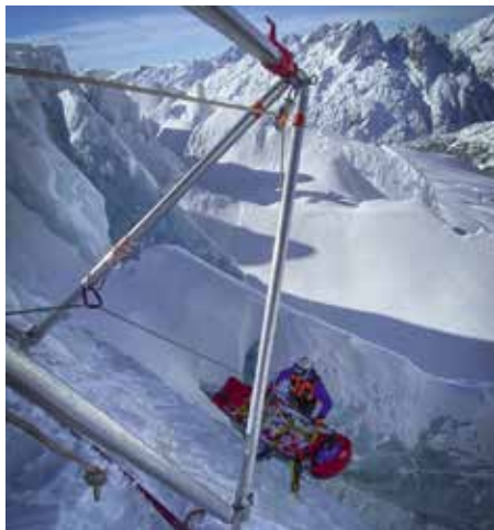
Évacuation d'une victime à l'aide d'une perche Franco Garda et d'un bipode
